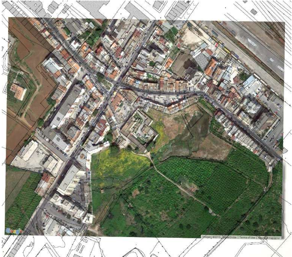
Fig. 12 – Disegno vettoriale della Carta Tecnica Comunale sovrapposto alla mesh triangolare texturizzata del terreno esportata da Google Earth Pro (Garofalo)
